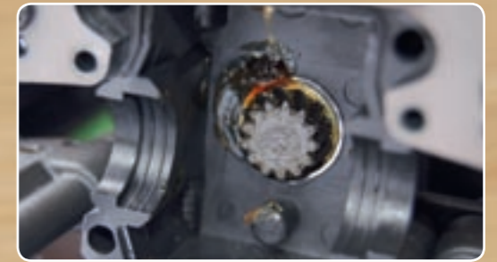
Da die Tellerräder der Differenziale schräg verzahnt sind, weist natürlich auch der Triebbling schräg angeordnete Zähne auf
