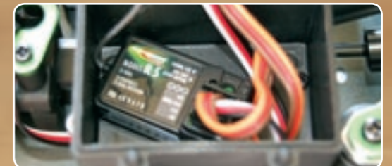
Ein wenig überdimensioniert ragt die Empfängerbox in die Höhe. Ordentlich Material zum auspolstern sollte bereit gelegt werden
