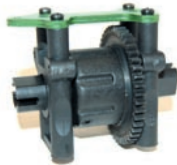
Das Mitteldifferenzial verfügt über ein Stahlhauptzahnrad
